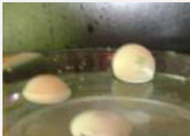
**Figura 7:** Flutuação em água de bolas de ping pong (uma oca, outra com areia e outra com limalha de ferro no seu interior)
