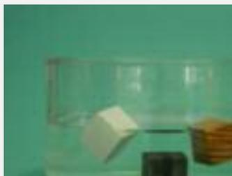
**Figura 5:** Flutuação de cubos feitos de materiais diferentes (madeira, PVC e ferro) em álcool etílico
